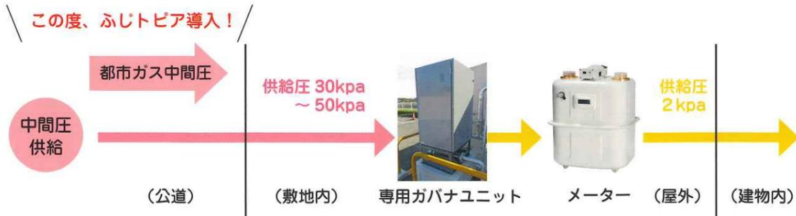
通常より圧力の高い本管(中間圧導管)で供給する方式
